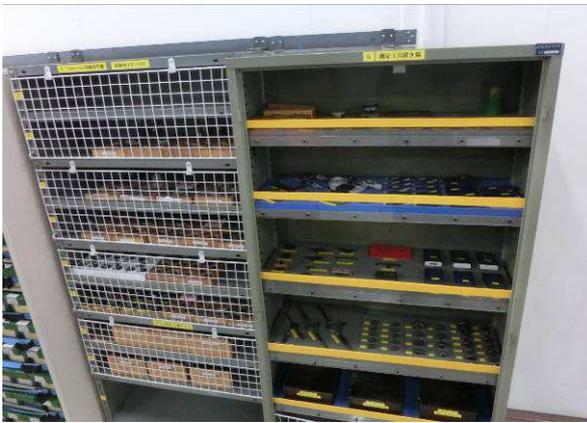
飛び出し防止の網の設置（手作り）
