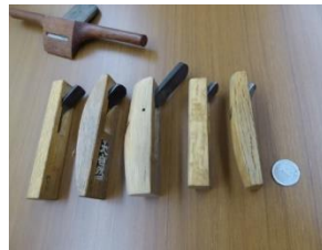
宮大工の仕事を支える自作のかんな。様々な大きさのかんなを駆使して木材を操る。
